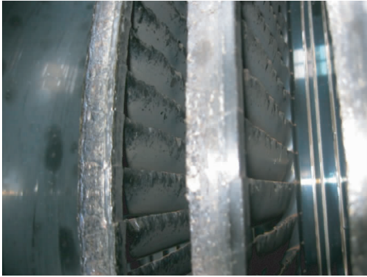
图 3 叶片的出汽边损坏和围带磨损
