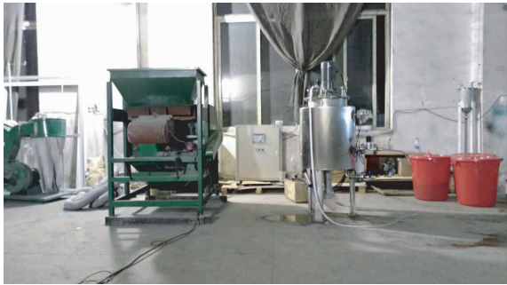
图 9 批量制备改性磁珠试验系统
