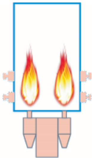
图 2 预热燃烧器与炉膛安装位置示意
