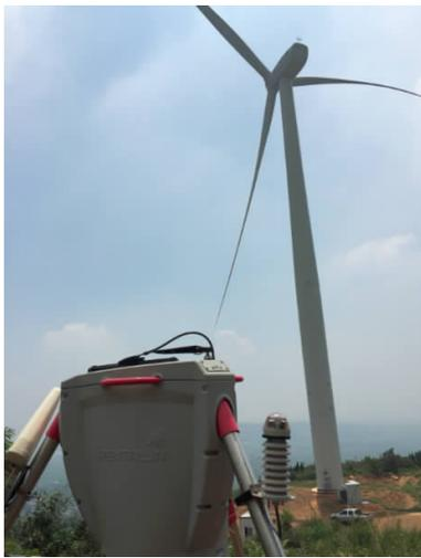
图 1 激光雷达测风仪现场布置图
