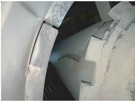
图3 碳化硅陶瓷管裂纹
