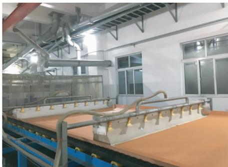
图 2 滤饼冲洗水布置现场
