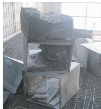
图 1 催化剂物理结构破坏
