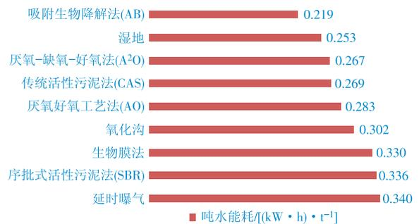
图 6 国内各种污水处理工艺吨水能耗
