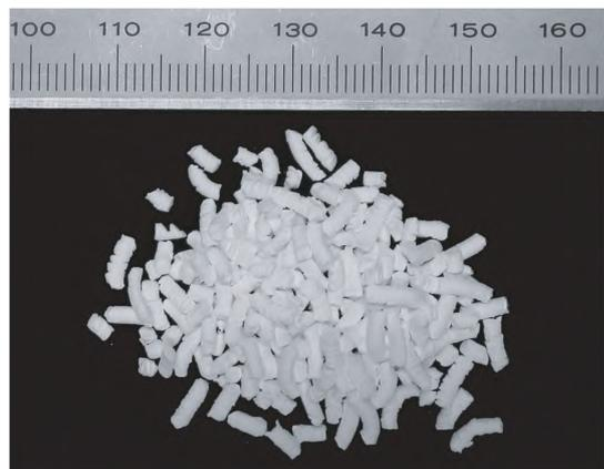
图2 高纯度圆柱形  $\text{Ca}(\text{OH})_2$  颗粒
