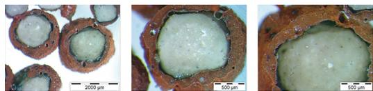
图5 球状核-壳型固体反应物颗粒
