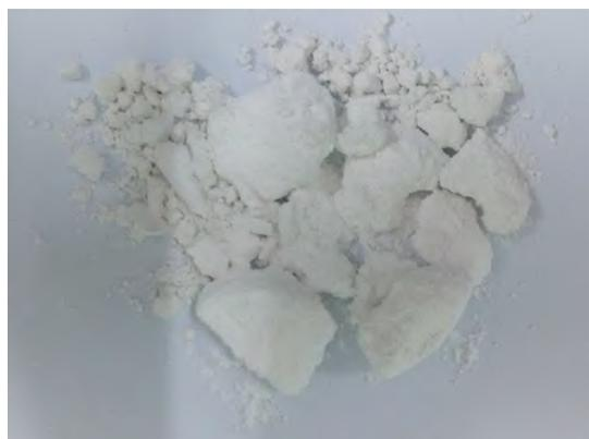
图1 20次反应循环后Ca(OH)<sub>2</sub>的团聚现象
